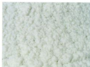
GSスプレーは1液ながらこの程度きれいに仕上げる ことができます。
